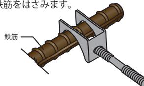
② ネジ部を回して鉄筋を絞め込みます。
